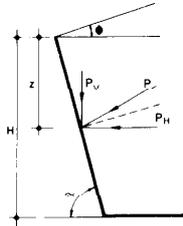
Los materiales almacenados producen sobre las paredes de los depósitos que los contienen una presión unitaria de componentes horizontales y verticales  $P_H$  y  $P_V$  cuyos valores en  $\text{kg/m}^2$ , en función de la profundidad  $z$  en m, del peso específico aparente  $\gamma$  en  $\text{kg/m}^3$  y de los coeficientes  $K_H$  y  $K_V$ , son:
