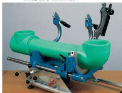
– Soldadura terminada después de enfriarse
