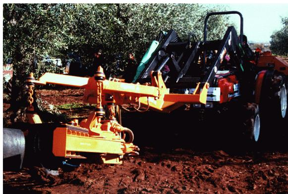
Figura 2.5.- Vibrador de inercia.
