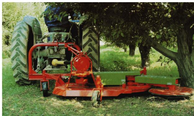
Figura 2.28.- Transmisión de potencia en trituradora de eje vertical.
