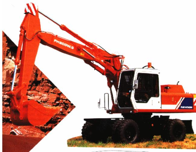
Figura 2.44.- Pala hidráulica sobre chasis con ruedas neumáticas.
