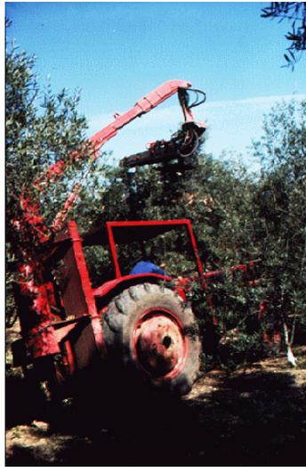
Figura 2.6.- Podadora mecánica aplicada a olivar intensivo.
