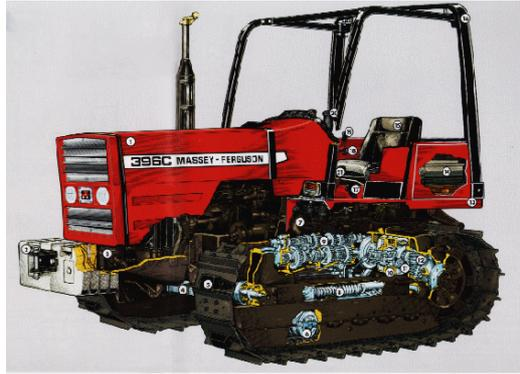
Figura 2.12.- Transmisión en un tractor de cadenas.
