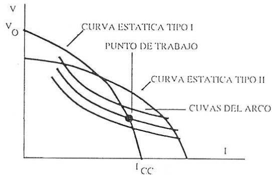
La intersección del diagrama estático de la fuente de corriente con la curva del arco proporciona el punto de trabajo durante el proceso de soldadura.
