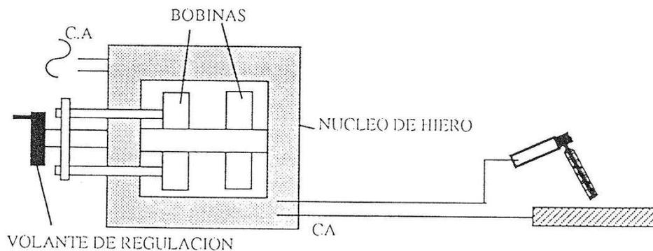
Este tipo de transformadores son los más baratos, y se emplean fundamentalmente para la soldadura con electrodo revestido y para TIG en aluminio.
