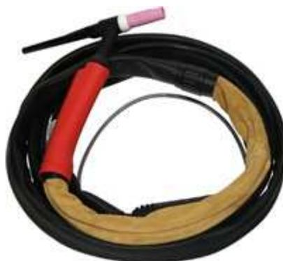
Las antorchas para proceso TIG pueden ir refrigeradas por aire o por líquido refrigerante. Como precaución se debe tener que antes del llenado del depósito, bomba y antorcha con líquido refrigerante, el circuito debe ser lavado bien con agua corriente y luego secarlo con aire comprimido. Generalmente, este líquido hay que cambiarlo cada 2 años aproximadamente. Como ejemplo de líquido refrigerante para soldadura es el BTC-15.
