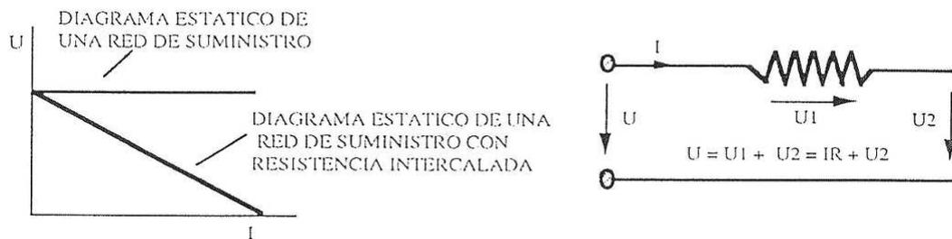
Para solucionar estos inconvenientes, la fuente de corriente que se emplea en soldadura está diseñada de forma que dé un potencial alto necesario durante la fase que dure de cebado del arco,
