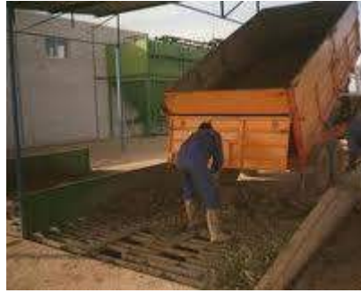
Descarga de aceituna en bruto en tolvas de recepción
