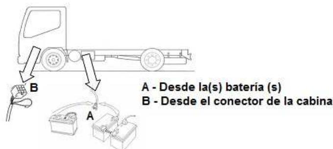
En general, en un camión se puede efectuar las tomas de corriente eléctrica desde dos puntos distintos:
