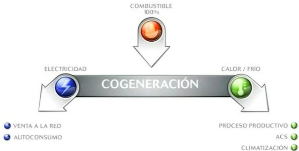
Figura 2.7. Entradas/salidas del sistema cogeneración.
