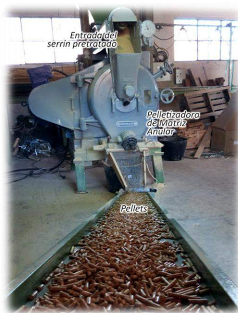
Figura 17: Enfriamiento natural de pellets
