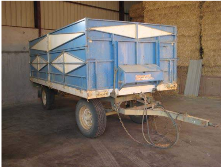
Figura 2.16: Remolque de dos ejes con el tiro sujeto por un muelle.
