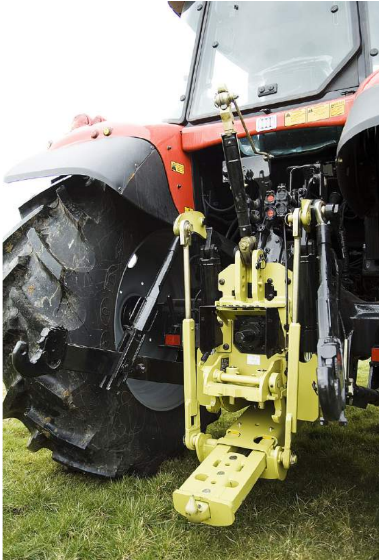
Figura 2.14: Push Back Hitch, propiedad de Dromone Ltd.
