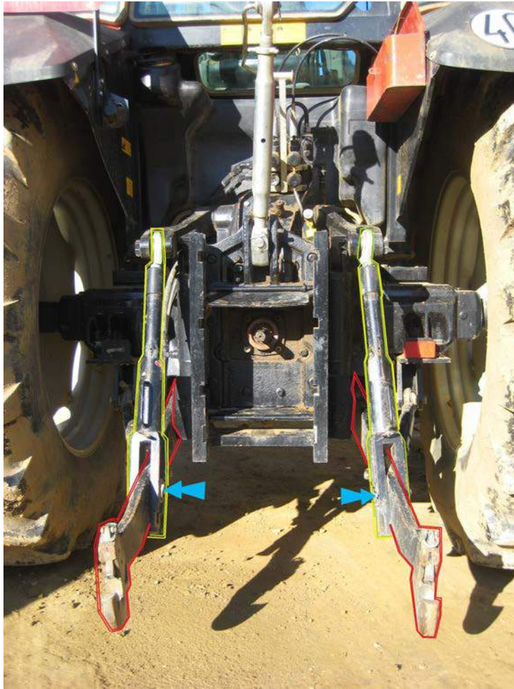
Figura 3.24: Esta imagen muestra de qué forma los brazos (en rojo) se acoplan a las bielas (en amarillo) mediante un pasador (marcado con una flecha azul).
