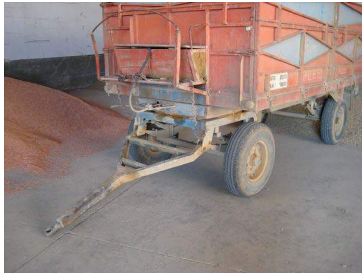
Figura 2.15: Remolque de dos ejes con el tiro apoyado sobre el suelo.
