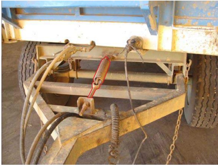
Figura 2.18: Detalle del muelle de sujeción central del tiro en rojo.
