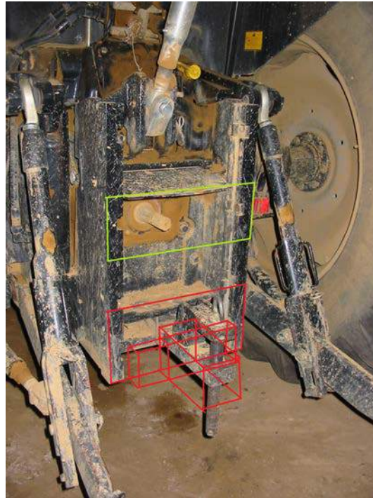
Figura 4.1: Gráfico superpuesto a una fotografía para proporcionar una idea de la posición y dimensiones del dispositivo con respecto al tractor.
