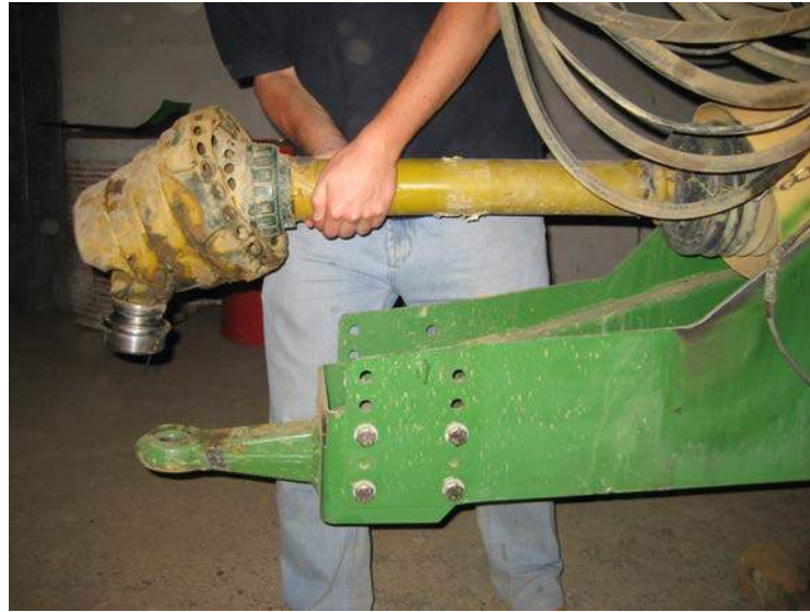
Figura 2.7: Imagen de la disposición de los elementos, argolla (parte inferior) y toma de fuerza cardan (parte superior).
