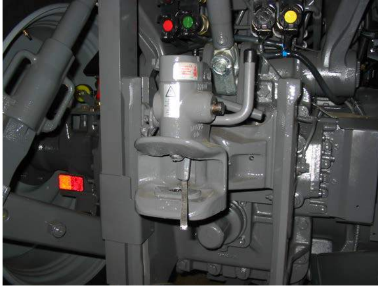
Figura 2.12: Enganche automático ROCKINGER RO-783 D montado en uno de los tractores de la gama alta de FENDT.
