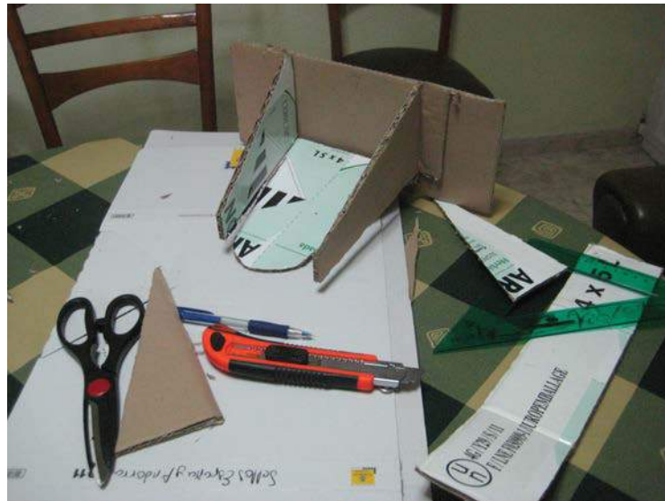
Figura 5.8: Las planchas de cartón anteriormente adheridas se recortan para dar forma.
