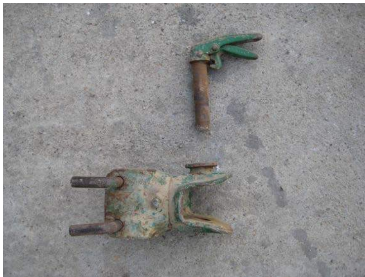
Figura 2.5: Enganche de fuerza desmontado perteneciente a un John-Deere 3130.
