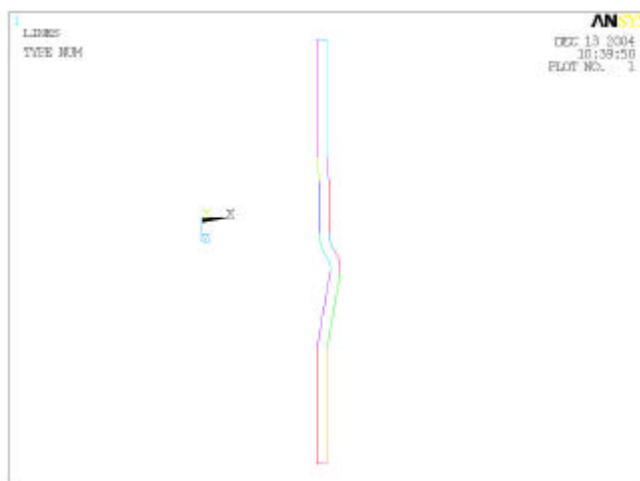
Ilustración 4-7. Líneas que se emplean inicialmente para generar la geometría del tubo.
